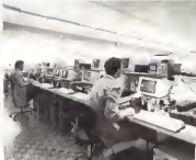
Una fase del collaudo delle schede prima del montaggio dei componenti, una fase della realizzazione del mister.
